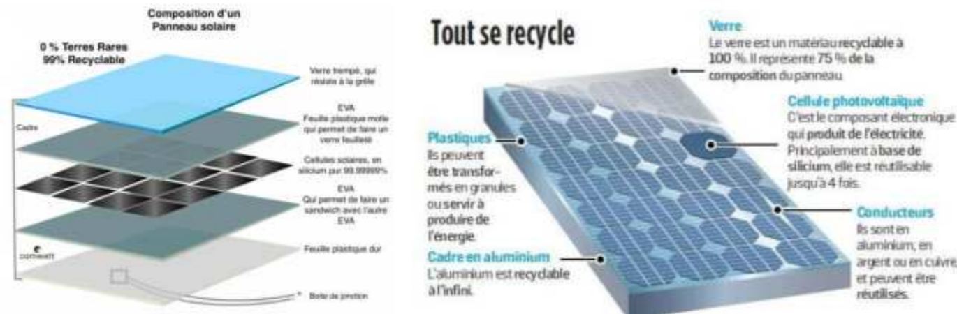
Figure 24 : exemple de composition d'un module photovoltaïque monofacial et cristallin (Source : ABO Energy)
