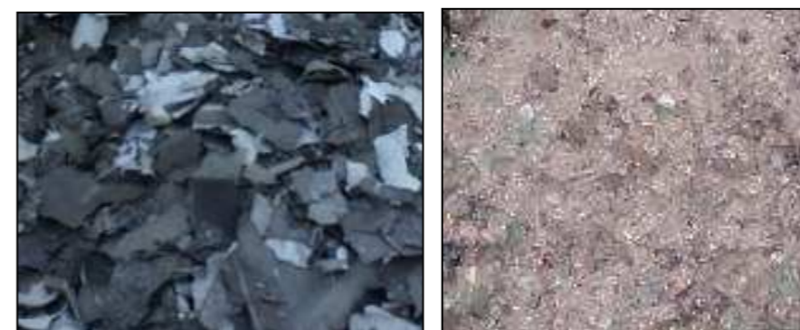
Figure 48 : Fragments de silicium et granules de verre (Source : PV CYCLE, photovoltaïque.info)
