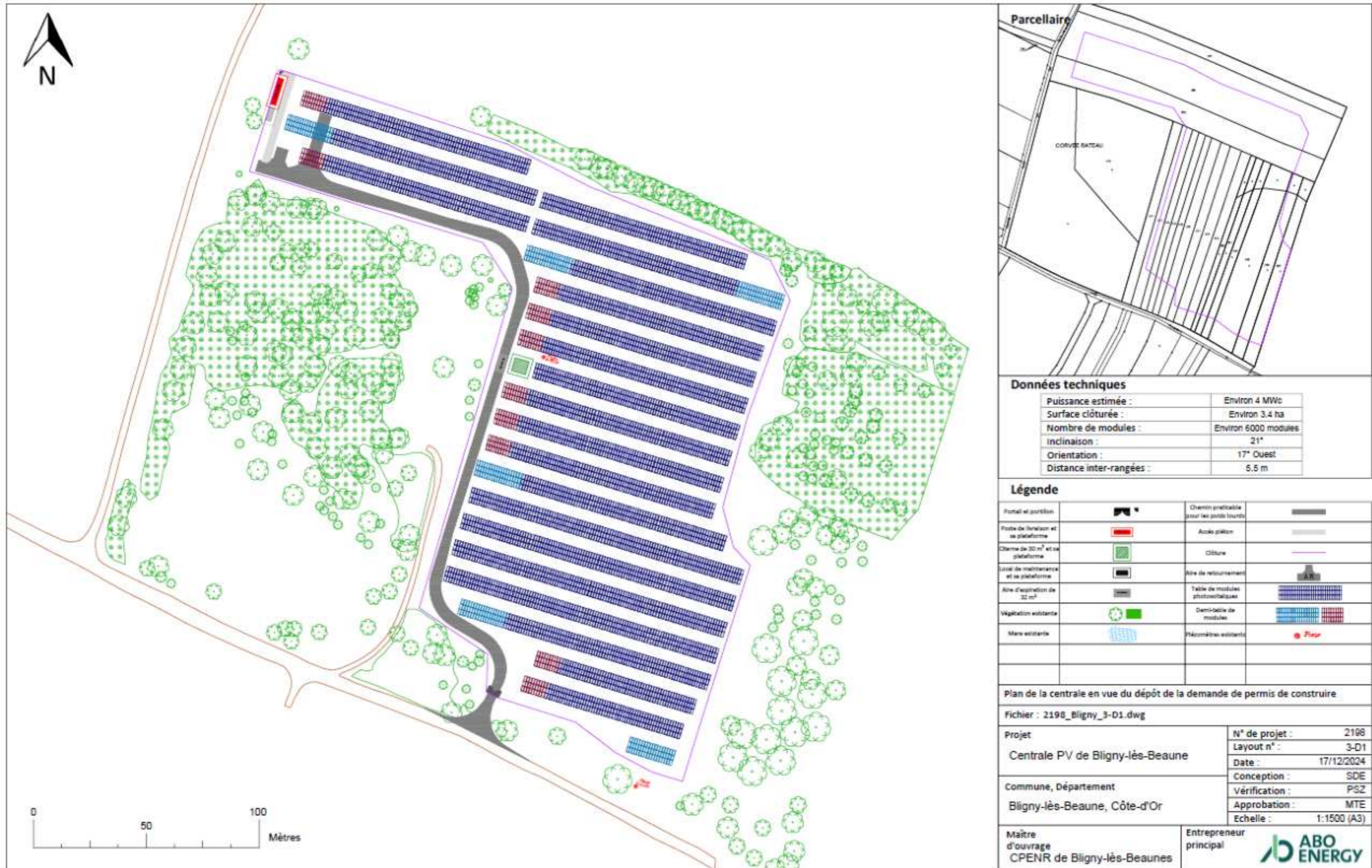
Figure 325 : Présentation de la variante n°3, soit la variante retenue pour le projet de centrale photovoltaïque au sol de Bligny-lès-Beaune (Source : ABO Energy)
